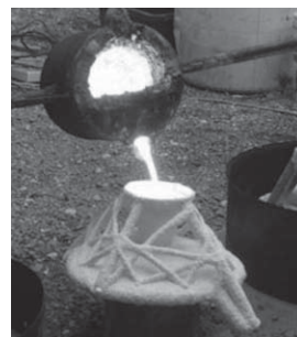
Gambar 7.8 Besi Cair Dituang ke Dalam Cetakan untuk Dibentuk
