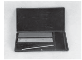
Gambar 1.2 Meter Standar yang terbuat dari batang platina iridium Sumber Gambar: www.ph.unimelb.edu.au
