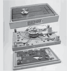
Gambar 6.8 Termostat yang Ada pada Pendingin Ruangan
