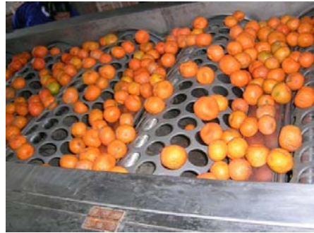
Gambar 1.1. Alat seleksi buah berdasarkan bentuk dan ukuran (sifat fisik) bahan pangan
