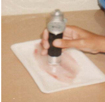
Gambar 1.3. Pnetrometer adalah salah satu alat yang dapat digunakan untuk mengukur kekenyalan daging
