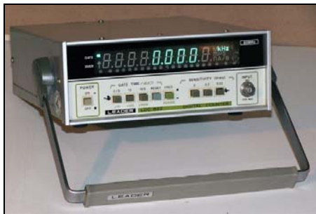
Gambar 2.12. Pencacah frekuensi dengan tampilan 8 digit merek Leader
