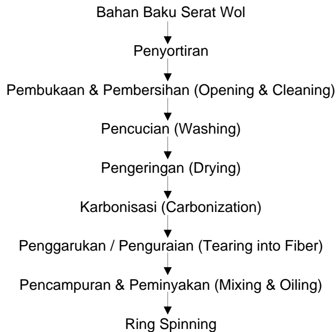
Gambar 5.11 Urutan Proses Pemintalan Benang Wol Garu
