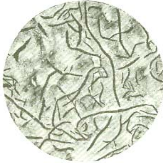
Gambar 3.17 Grey Cast Iron : Flakes Graphite pada struktur Pearlite
