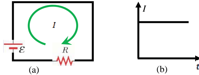
Gambar 11.1 (a) Resistor R dihubungkan dengan batere \varepsilon (b) Sesuai hukum Ohm, arus I konstan terhadap waktu.
