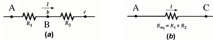
Gambar 10.12 (a) Gambaran secara sederhana dua resistor R_1 dan R_2 disambungkan seri dan dilalui arus I . (b) Resistansi ekuivalen atau resistansi pengganti menyatakan semua arus dalam rangkaian seri adalah sama.
