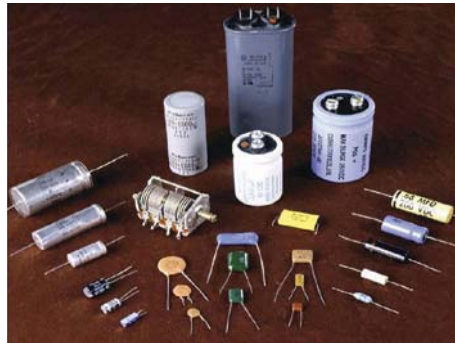
Gambar 11.5 Berbagai bentuk dan jenis kapasitor. Kapasitansi didefinisikan sebagai
