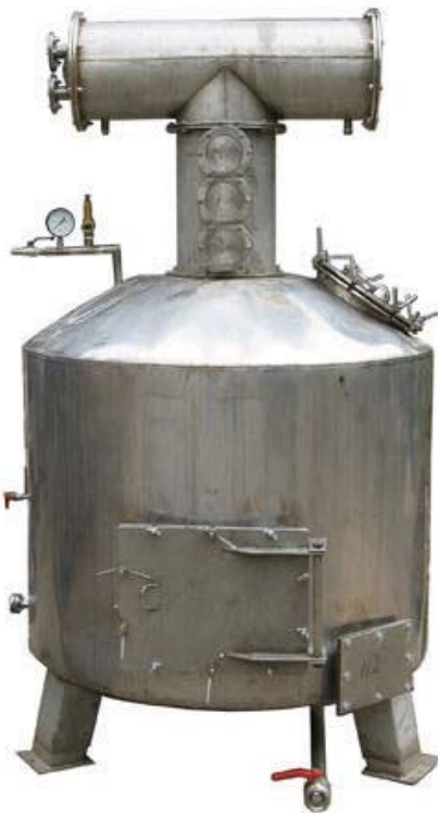
Gambar 4.79: Peralatan ekstraksi skala industri kecil
