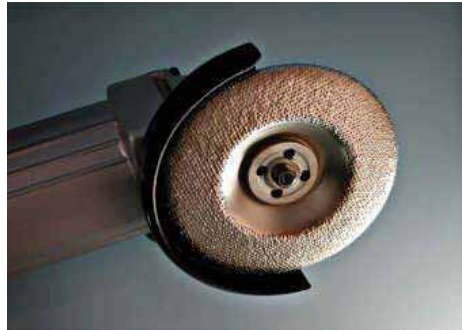
Gambar 11.10. Pemasangan Roda gerinda Pada Mesin Gerinda
