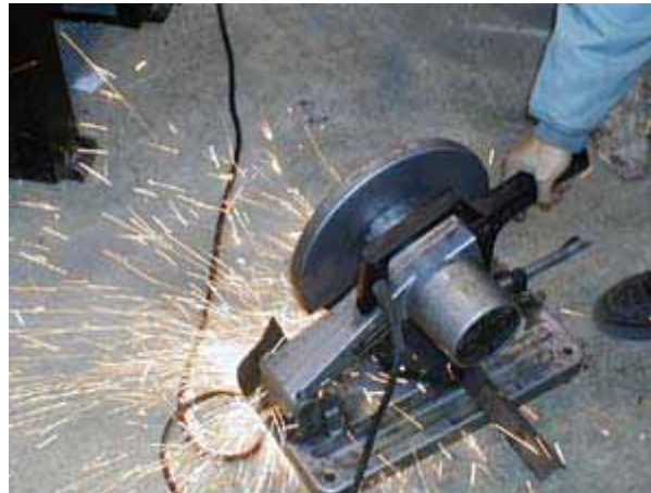
Gambar 11.23. Pekerjaan pemotongan benda kerja dengan gerinda potong
