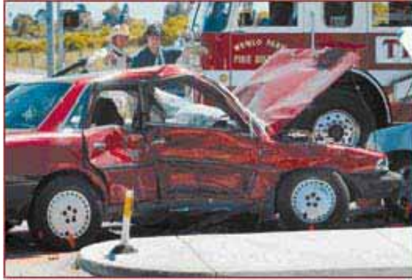
Gambar 15.4 Kerusakan bodi akibat tabrakan
