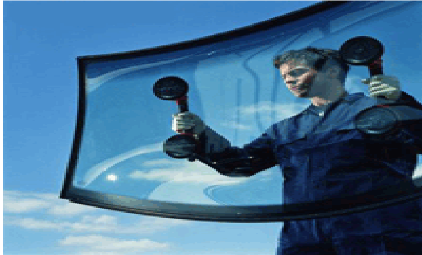
Gambar 14.26 Teknisi mengangkat kaca dengan vacuum cup
