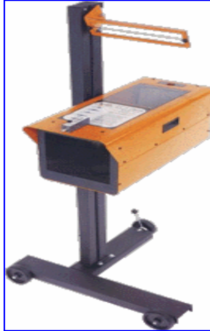
Gambar 16.33. Menyetel jarak lampu
