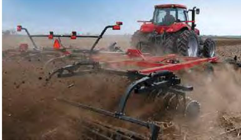
Gambar 10. Alat dan mesin pengolahan tanah pertama (*Primary tillage equipment*)
