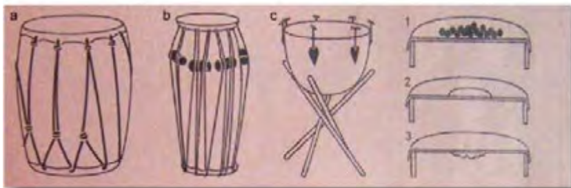
Gambar 111: Menyetem instrumen membranophone a. Mengatur cincin pada simpul tali b. Mengatur penyangga yang terdapat pada tali. c. Memutar "tuning machine"
