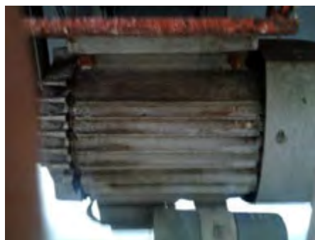
Gambar 60. motor penggerak pada mesin pencampur adonan
