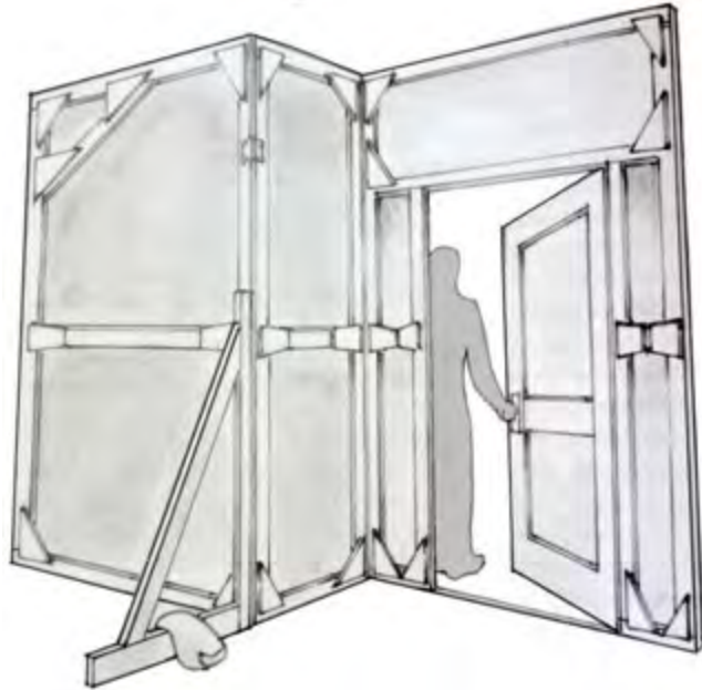
Gambar 56. Flat disusun membentuk dinding ruang
