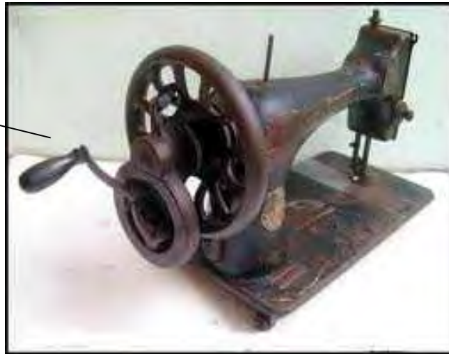
Gambar 3.1 Mesin jahit manual dengan penggerak tangan
