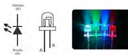
Gambar 3-2.7. Konstruksi dan simbol LED
