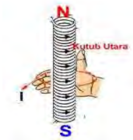
Gambar 2-1.10 Menentukan kutub Solenoid dengan metode tangan kanan
