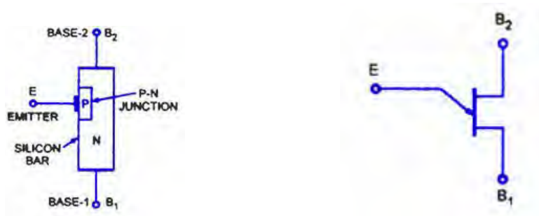
Gambar 3-4.15 UJT a. Susunan UJT, b . Lambang skematik
