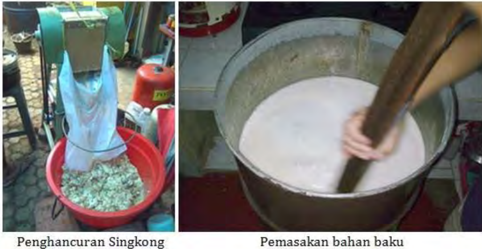
Gambar 12. Proses pengecilan ukuran dan pemasakan sebagai langkah awal proses liquifikasi
