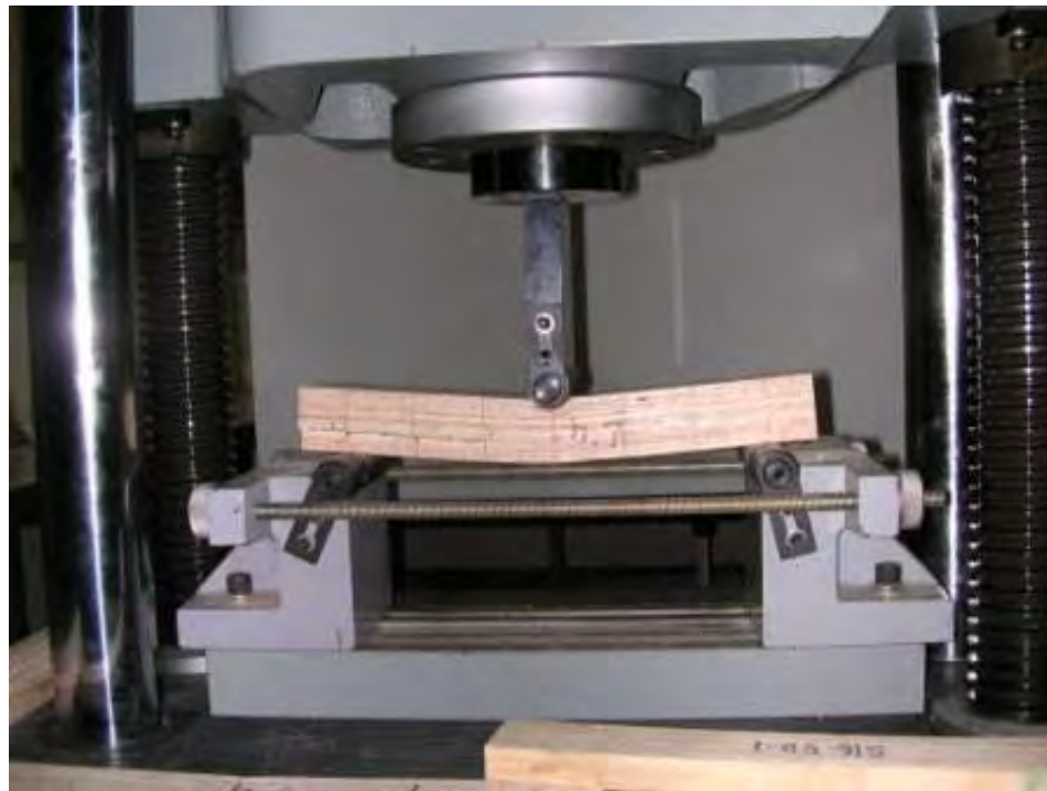
Gambar 44. Aplikasi pengujian lentur pada kayu http://ft.unpar.ac.id/program-studi/teknik-sipil/komunitas-bidang-ilmu/teknik-struktur/laboratorium/
