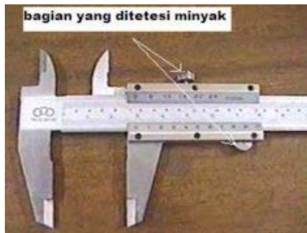
Gambar 4.1. Bagian jangka sorong yang ditetesi minyak
