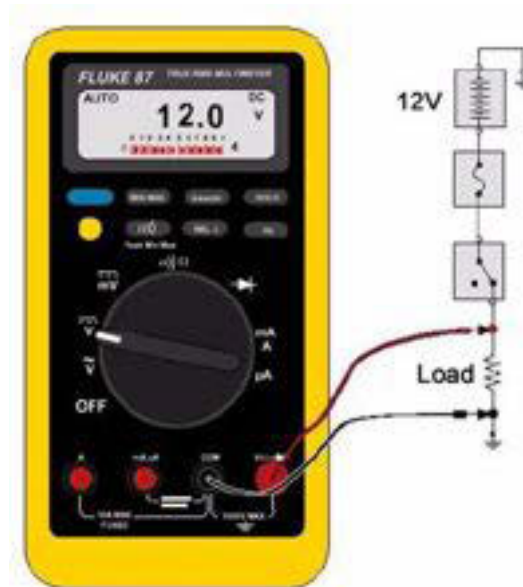
Gambar 2.13. Mengukur penurunan tegangan
