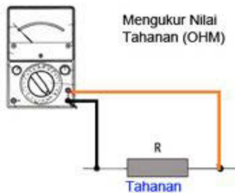
Gambar 2.4. Memasang Multimeter untuk mengukur tahanan
