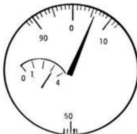
Gambar 1.64. Skala pengukuran dial indikator
