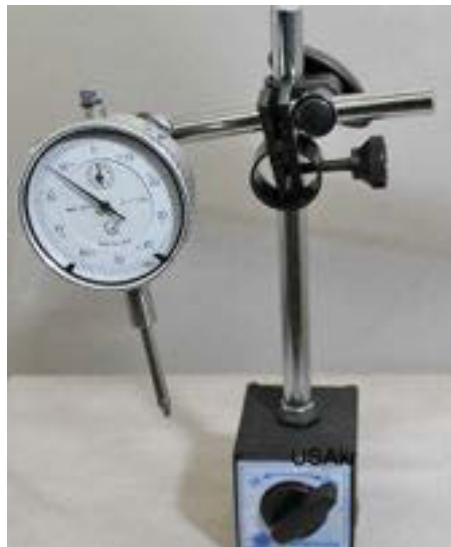
Gambar 1.62. Dial Indicator Dengan Magnetic Base .
