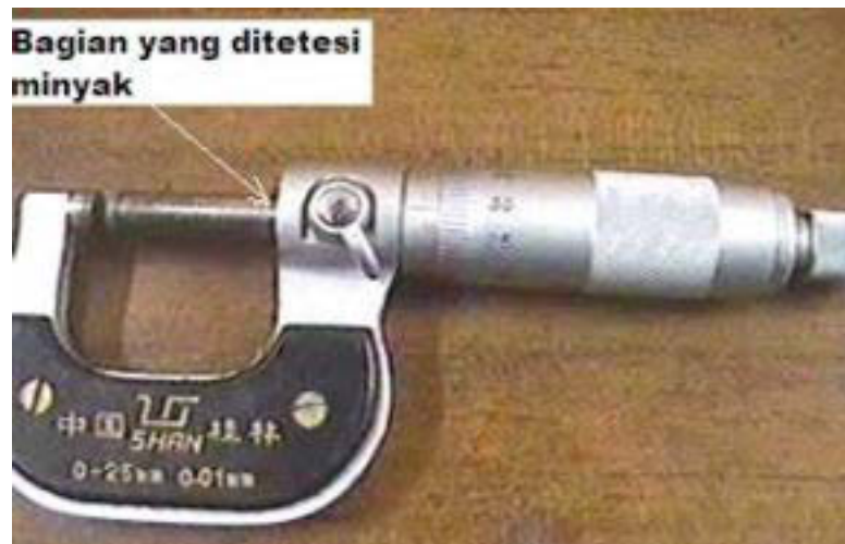
Gambar 4.4. Bagian mikrometer yang ditetesi minyak
