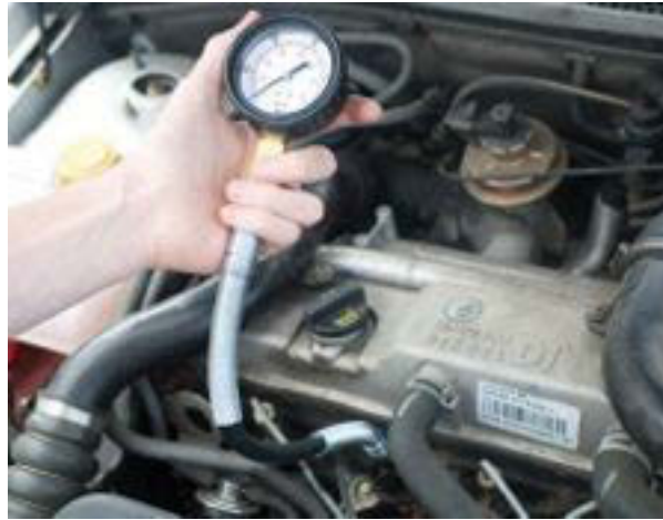
Gambar 3.14. Pengukuran tekanan kompresi
