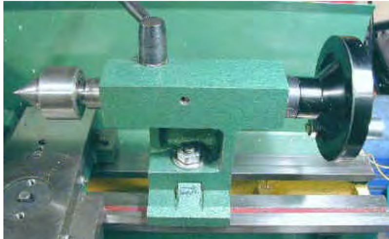
gambar 2.28 Pemasangan Center Putar
