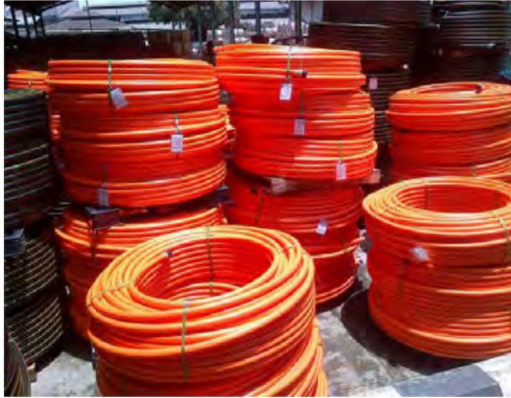
Pipa HDPE (high-density polyethylene) adalah pipa yang terbuat dengan bahan polyethylene dengan kepadatan tinggi sehingga jenis pipa yang dihasilkan dapat menahan daya tekan yang lebih tinggi. Karakteristik pipa HDPE adalah kuat, lentur/flexible dan tahan terhadap bahan kimia.
