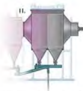
Gambar 7. Pembersihan gas buang dengan presipitator statik
