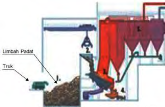
Sumber: http://iax357.blogspot.com/2012/11/Pengolahan-Limbah-Padat-Industri Gambar 5. Cara Kerja Pengumpulan dan Pembakaran Limbah Padat
