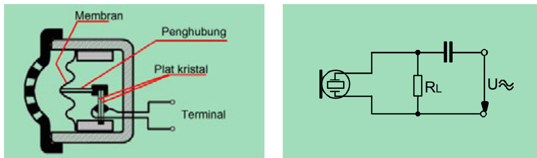
Gambar 4.10. Kunstruksi mikropon kristal (kiri) dan rangkaian mikropon kristal
