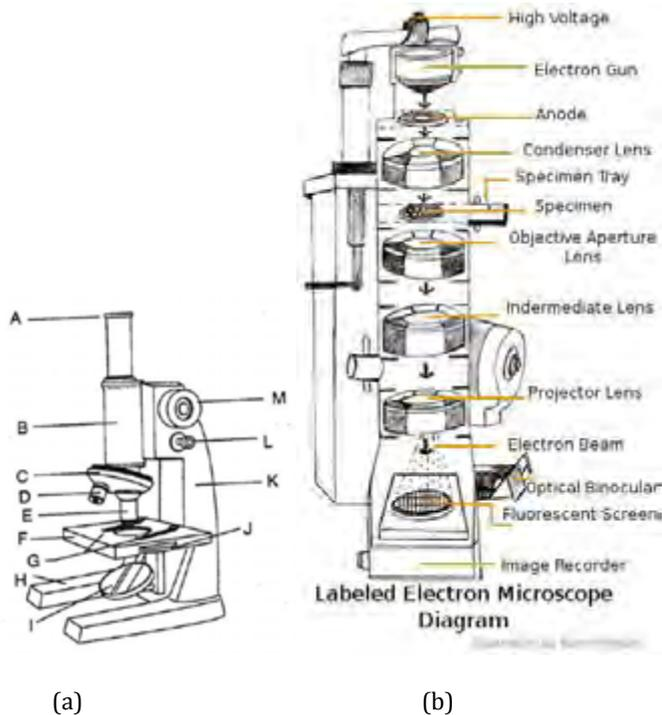
**Gambar 18. Bagian-bagian mikroskop cahaya (a) dan mikroskop elektron (b)**
