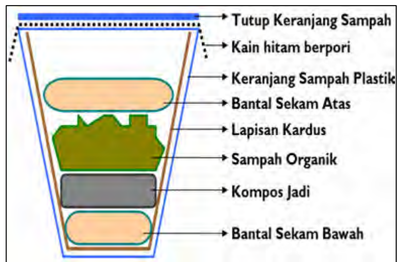
Gambar 43. Susunan bagian dalam keranjang Takakura
