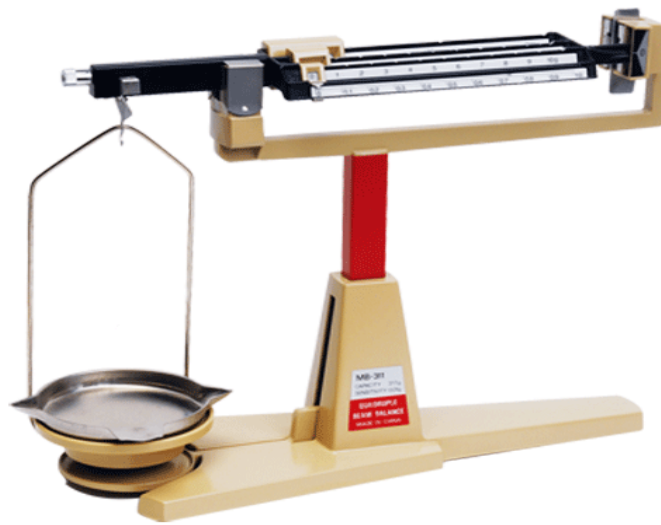
Gambar 2. Neraca Satu Piring - Tiga Lengan Sumber: http://www.easthighscale.com
