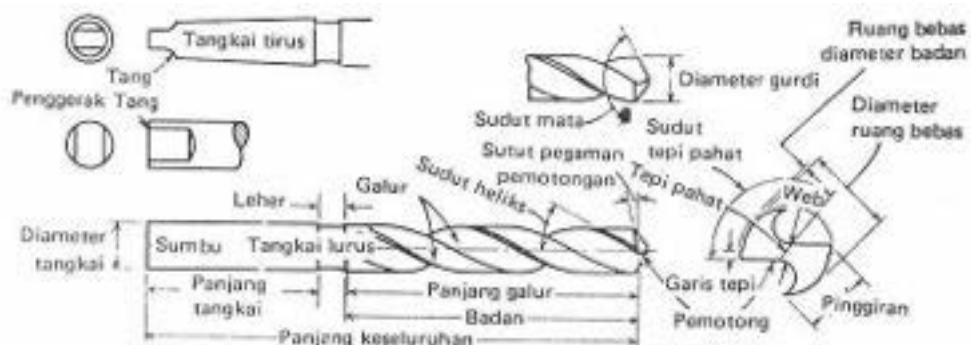
Gambar 7.32 Bagian-bagian mata bor
