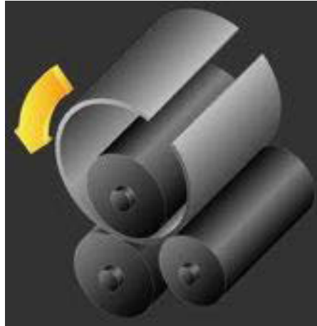
Gambar 2.3 Proses Pengerolan Pelat
