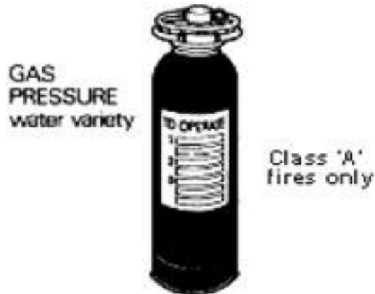
Gambar 14. Pemadam kebakaran yang berisi air
