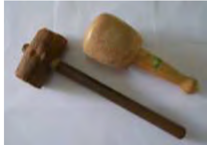
Gambar 1-7. Palu Kayu/Ganden Sumber: Buku Kriya Kayu SMK, Enget dkk
