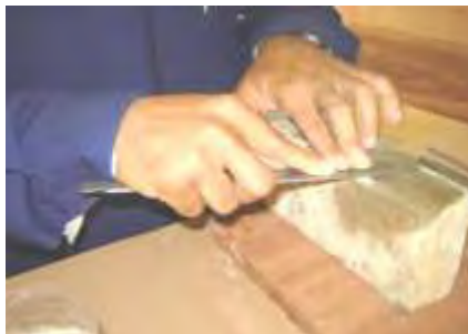
Gambar 2-13. Cara mengasah pahat penyilat/lurus bagian luar.
