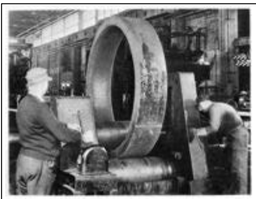
Gambar 9.33. Pengerolan pelat di industri
