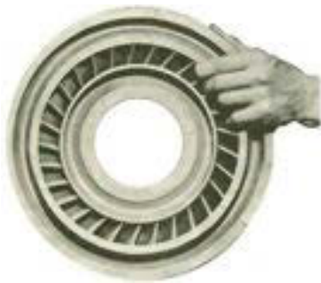
Gambar 8.35 "Turbinge Nozle" salah satu produk pengecoran air or vacuum Alloys
