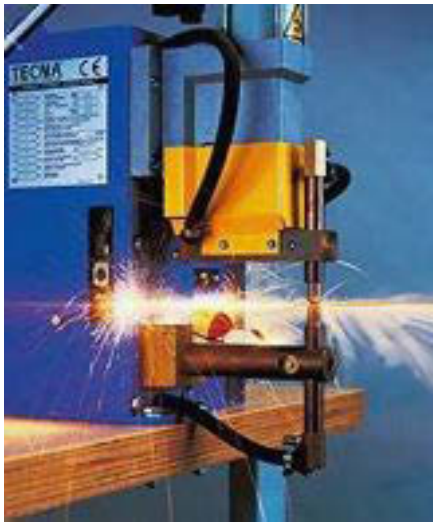
Gambar 5.5 proses las resistansi
