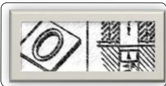
Gambar 9.5. Penembukan dengan penahan press
