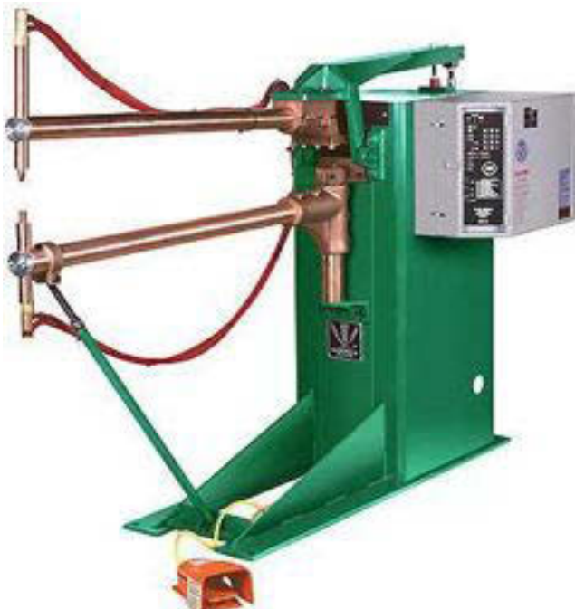
Gambar 5.2 las resistansi titik dengan penggerak tuas tangan
