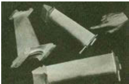
Gambar 8.34 "Land Base Turbing Airfoils" salah satu produk pengecoran dengan metode investment casting
