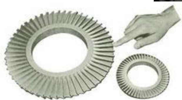
Gambar 8.36 "Turbine-wheel" salah satu produk pengecoran Precision Casting dari paduan Cobalt alloy dan Nikel Alloy (Vacuum-Casting Alloys) dengan ukuran yang lebih besar dibentuk dengan metoda Investment casting.
