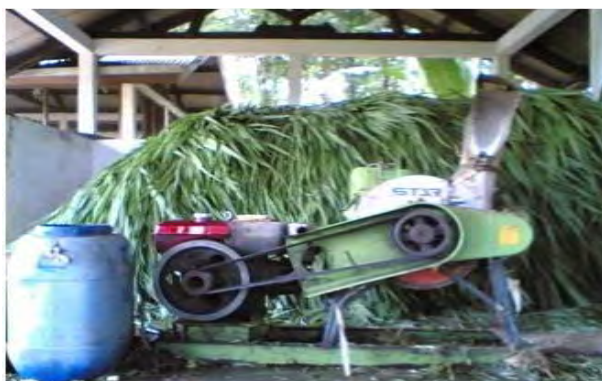
Gambar 16. Chopper (mesin memotong/ mencacah rumput )
