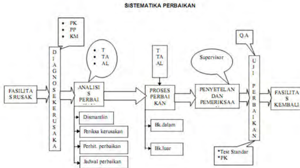
Gambar 6.1 Skema Sistematika Perbaikan
