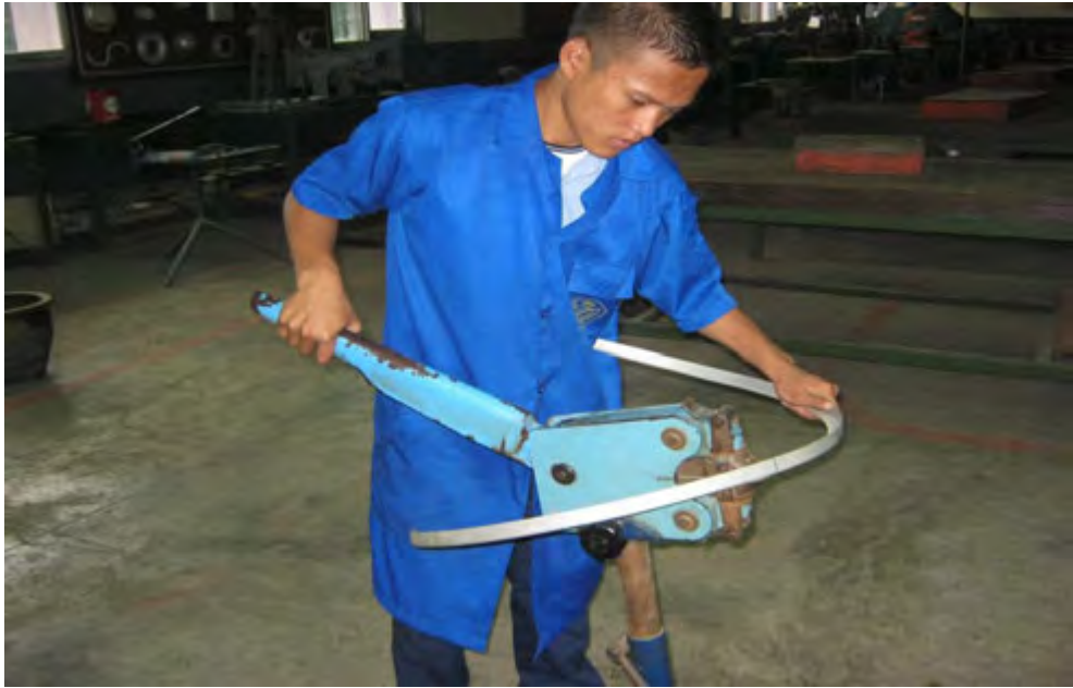
Gbr. 4.19 : Proses pengkerutan material siku dengan mesin eckold
