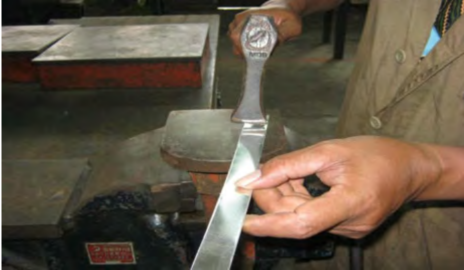
Gbr. 3.5 : Peregangan bagian tengah
