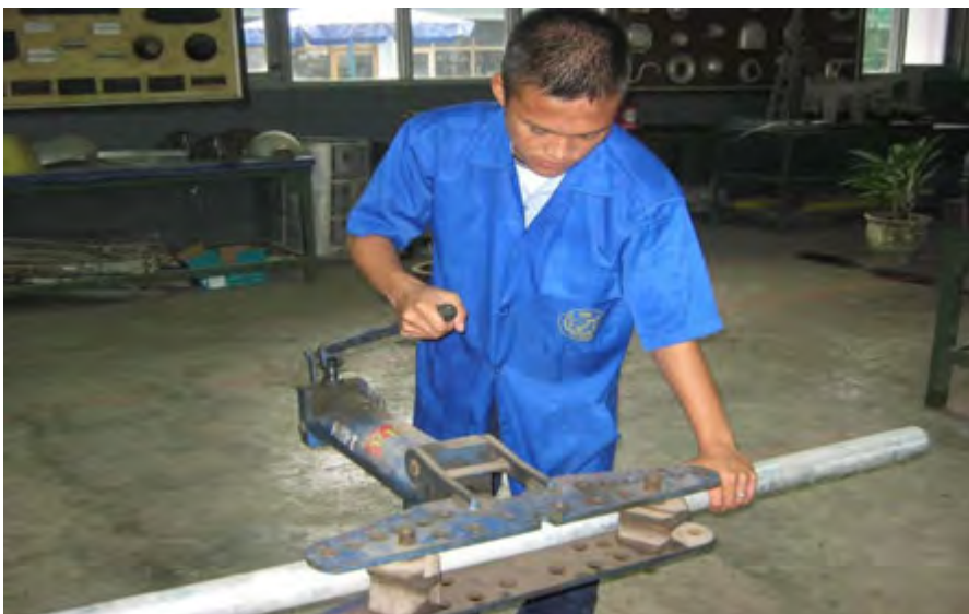
Gbr. 4. 12 : Proses pembengkokan pipa secara hidrolik
