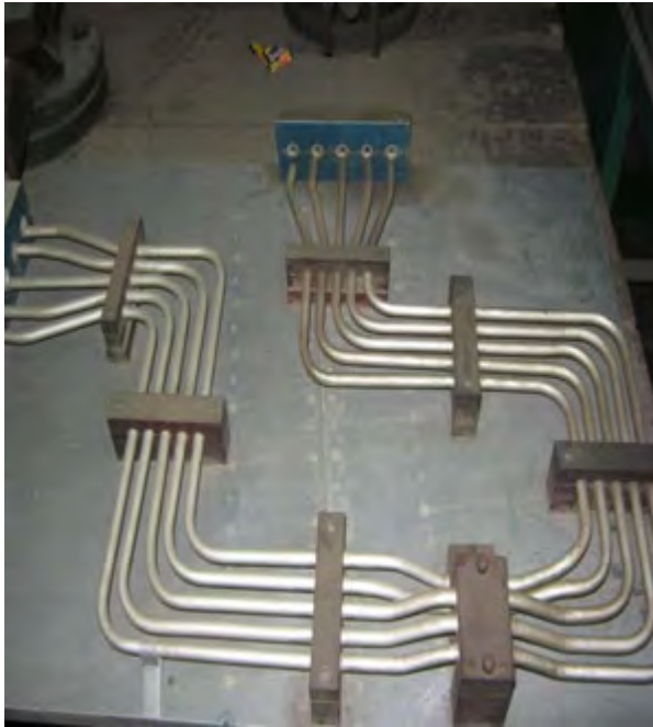
Gbr. 4. 11 : Hasil pembengkokan pipa alumunium
