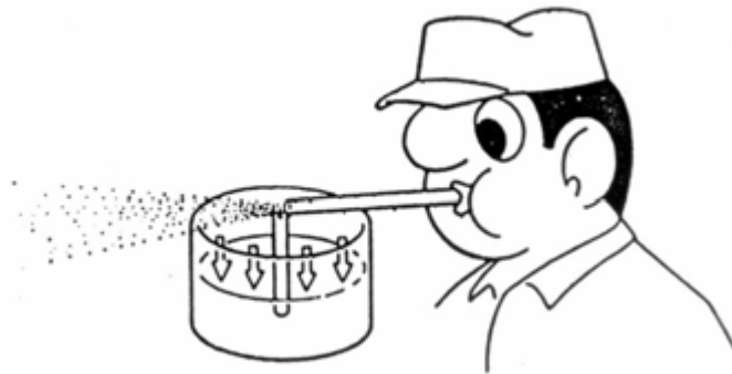
Gambar 5.25 Prinsip Kerja Karburator
