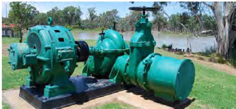
Gambar 83. Pompa Sentrifugal dengan Penggerak Motor Listrik
