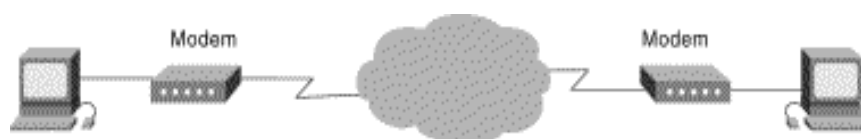
Gambar 2.34. Sambungan ke WAN melalui Modem
