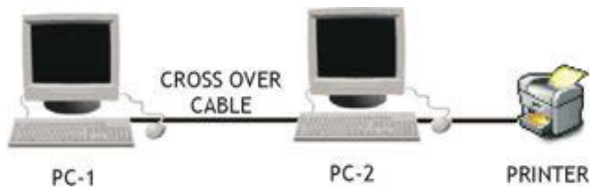
Gambar 2.24. LAN Peer-to-Peer hubungan langsung.
