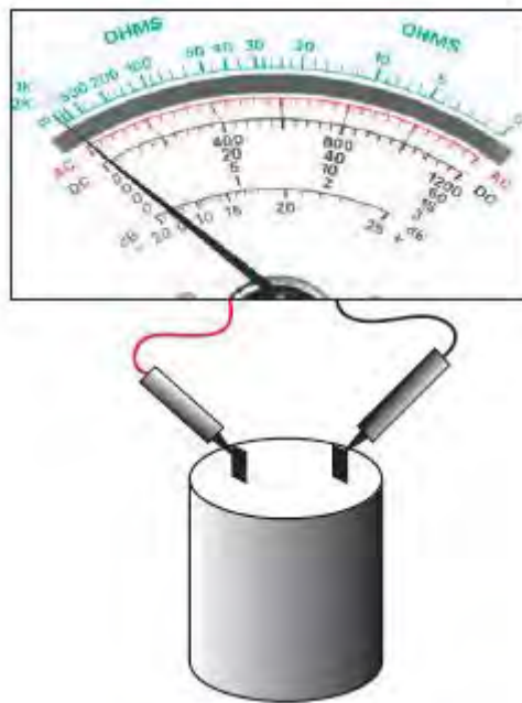
Gambar 5.7 Kapasitor Putus Jarum Meter Tidak bergerak
