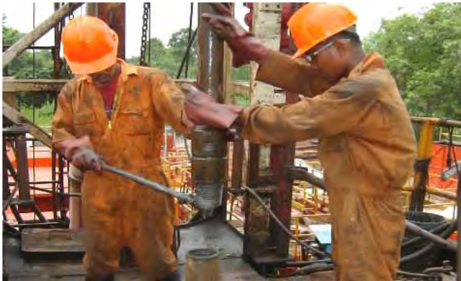
Gambar 5.4 Mengangkat Pipa dari Pipe Rack
