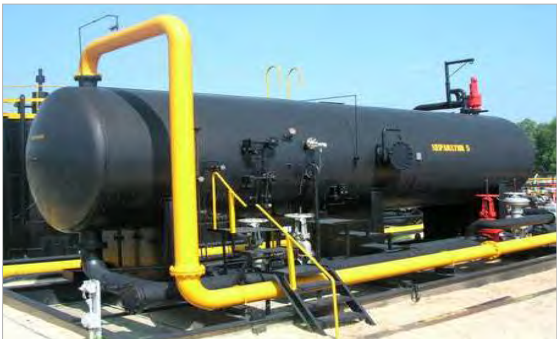
Separator horizontal untuk memisahkan gas dari cairan
