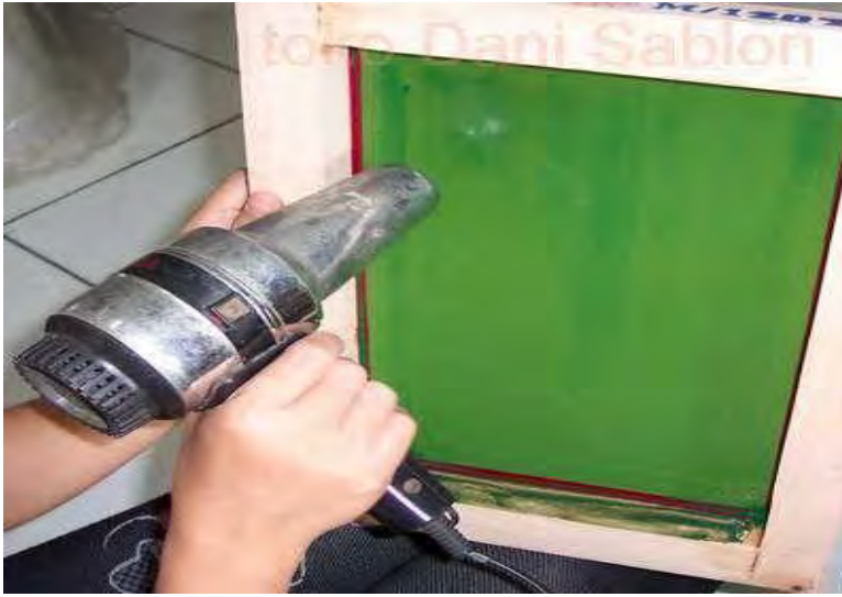
Gbr. 9. Pengeringan screen setelah dilapisi emulsi
