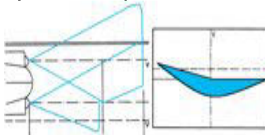
Gambar 1.17 Proyeksi sinar lampu dekat asimetris Eropa pada papan penyetel
