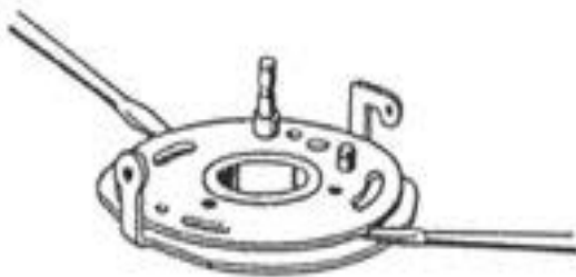
Gambar 18.1 Pemeriksaan keausan pada plat dudukan kontak pemutus
