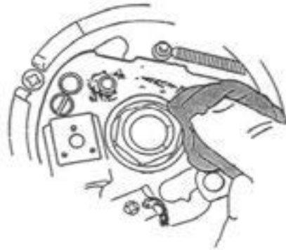
Gambar 14.11 Membersihkan plat dukungan kontak pemutus dan kam governor dengan lap
