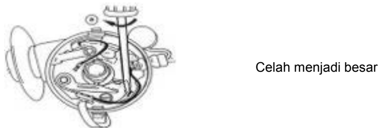
Gambar 14.17 Mengatur pembukaan kontak pemutus, Celah menjadi besar
