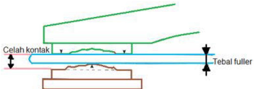
Gambar 14.12 Kontak pemutus yang tidak rata
