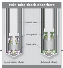
Cara kerja pada saat compresion stroke terjadi fluida tertekan mengalir dari silinder dalam bagian bawah ke silinder dalam bagian atas melalui katup pada piston. Fluida juga mengalir dari silinder dalam ke silinder luar, melalui katup kontrol yang berada pada dasar silinder. Karena perpindahan fluida ini, menjadikan peredam getaran. bekerja. Peredam terhadap
