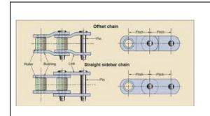
a) Jenis straight-pin. Bentuk dari poros pin lurus, sehingga pin dengan mudah dapat dilepaskan.
