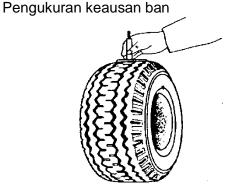
Keausan telapak ban yang dijalankan, kira – kira 1 ÷ 1,6 mm dari permukaan TWI ke permukaan telapak ban.
