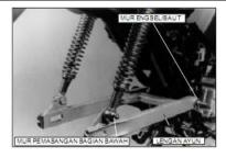
Pasang rantai roda dan pasang lengan ayun pada rangka. Masukkan baut engsel dari sisi kiri dan untuk sementara kencangkan mur engsel.
