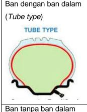
Di dalamnya terdapat ban dalam untuk menampung udara yang dipompakan ke dalam ban. Katup atau pentil (air valve) yang menonjol keluar melalui lubang pelek menjadi satu dengan ban dalam (diistilahkan sebagai tube valve).
