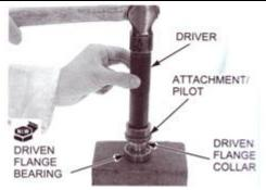
Dorong masuk driven flange collar ke dalam driven flange bearing baru tertutup dengan sisinya yang menghadap ke bawah.
