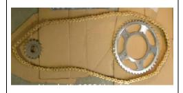
b) Endless, merupakan rantai roda sepeda motor tanpa menggunakan sambungan (master link) sehingga tidak dapat dilepas tanpa merusak konstruksi rantai. Rantai jenis endless umumnya digunakan pada sepeda motor besar,
