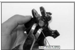
Pasang klip pengunci pada alur di dalam silinder utama.
