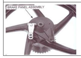
Lepaskan *brake panel assembly* dari *right wheel hub* (pusat roda sebelah kanan)
