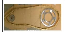
b) Endless, merupakan rantai roda sepeda motor tanpa menggunakan sambungan (master link) sehingga tidak dapat dilepas tanpa merusak konstruksi rantai. Rantai jenis endless umumnya digunakan pada sepeda motor besar, misalnya Honda CB750.
