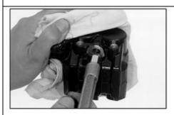
Letakkan sebuah lap bengkel di atas piston. Posisikan badan caliper sehingga piston menghadap ke bawah dan semprotkan udara dalam tembakan-tembakan singkat ke dalam lubang pemasukan minyak rem pada caliper untuk membantu mengeluarkan piston.
