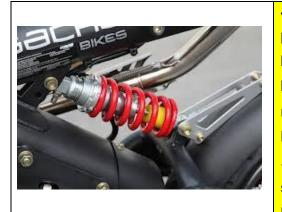
Jenis suspensi ini mempunyai satu peredam kejut yang mendukung bagian belakang frame body dan bagian swing arm. Suspensi ini memiliki kontruksi yang rumit, tetapi lebih stabil dibanding jenis double suspension. Banyak digunakan pada sepeda motor modern untuk keperluan sport.
