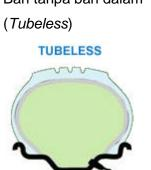
Ban *Tubeless* tidak menggunakan ban dalam. Tekanan udara hanya ditahan oleh lapisan dalam ban, yaitu lapisan karet yang kedap udara. Karena ban *tubeless* tidak menggunakan ban dalam, maka pentil ( *air valve*) langsung dipasang pada pelek (diistilahkan sebagai *rim valve*).
