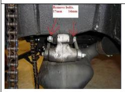
iv. Lepaskan mur-mur pemasangan peredam kejut bagian bawah.
