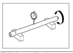
Letakkan tabung garpu pada blok-V dan ukur keolengan. Keolengan yang sebenarnya adalah 1/2 dari pembacaan total indikator. Bandingkan dengan keolengan yang dijjinkan.
