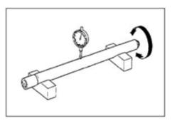
Letakkan tabung garpu pada blok-V dan ukur keolengan. Keolengan yang sebenarnya adalah 1/2 dari pembacaan total indikator. Bandingkan dengan keolengan yang diijinkan.
