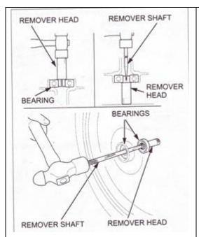
Pasang bearing remover ke dalam wheel bearing. Dari sisi yang berlawanan pasanglah bearing remover shaft dan dorong bearing kelua dari wheel hub.
