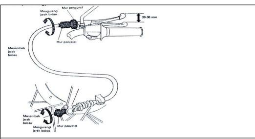
Penyetelan jarak main bebas tuas/pedal rem (depan): 10 – 20 mm
