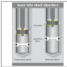
Hanya terdiri dari satu tabung dan posisi tabung berada pada bagian atas. Bagian utama terdiri dari tutup (cover), silinder bagian atas (upper chamber), silinder bagian bawah (lower chamber) dan piston dilengkapi lubang-lubang kecil (orifice) sebagai katup.
