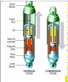
Ditekan (compression cycle) Saat shock absorber ditekan karena gaya osilasi dari pegas suspensi, maka gerakan yang terjadi adalah shock absorber mengalami pemendekan ukuran. Pada saat inilah piston bergerak turun ke bawah. Fluida shock absorber yang berada di bawah piston akan naik ke ruang di atas piston melalui lubang yang ada pada piston. Sementara lubang kecil (orifice) pada piston tertutup karena katup menutup saluran orifice tersebut.
