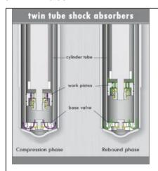
Terdiri dari dua tabung dan posisi tabung berada pada bagian bawah. Bagian utama tutup (cover), tabung luar (outer tube absorber shell), tabung dalam (pressure tube) dilengkapi katup kontrol (cheek valve), silinder luar (reservoir chamber), silinder dalam (working chamber) dan piston dilengkapi lubang-lubang kecil (orifice) sebagai katup.
