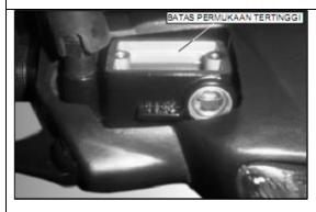
Isilah kotak minyak rem dengan minyak rem DOT 4 sampai tanda batas permukaan tertinggi.
