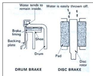
Water recovery yang lebih baik dibandingkan dengan sistem rem tromol, hal ini disebabkan karena air akan terlempar keluar dari permukaan cakram dan pad karena adanya gaya sentrifugal. Pada rem tromol tetap akan menyisakan air di antara sepatu rem dan tromol sehingga koefisien gesek rem menjadi rendah.
