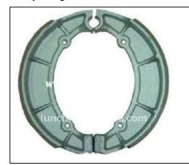
Sepatu rem terdiri dari sebuah meja dan pelapis sepatu (shoe web). Lapisan atau kampas rem (brake lining) dipasang pada meja sepatu rem dengan cara pengeleman atau kelingan. Lapisan sepatu menahan meja dan pegas pengembali sepatu (shoe return spring).
