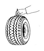
Keausan telapak ban yang dijalankan, kira – kira 1 ÷ 1,6 mm dari permukaan TWI ke permukaan telapak ban. Saat melakukan pengukuran keausan telapak ban, ban harus diisi tekanan angin yang normal.
