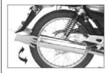
Menempatkan sepeda motor pada standar utama, goyangkan lengan ayun ke kanan-kiri.
