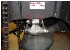
iv. Lepaskan mur-mur pemasangan peredam kejut bagian bawah.
