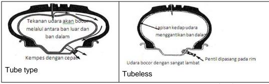
2. Hemat tenaga kerja. Pada saat ban dipasang pada pelek (rim), tidak ada bagian yang lebih sukar dari pada memasang/menyelipkan ban dalam dan lapisan pelindung (flapnya), pemompaan tekanan udara secara bertahap untuk kepentingan memonitor agar flange rim dan ring pengunci
