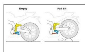
Kontruksi tipe *unit swing* adalah mesin itu sendiri yang bereaksi seperti lengan yang berayun. Jadi mesin tersebut yang berayun. Tipe sistem suspensi ini digunakan untuk sepeda motor *scooter* dan sebagian moped.
