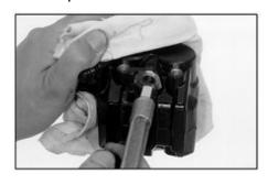
Letakkan sebuah lap bengkel di atas piston. Posisikan badan caliper sehingga piston menghadap ke bawah dan semprotkan udara dalam tembakan-tembakan singkat ke dalam lubang pemasukan minyak rem pada caliper untuk membantu
