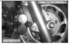
Pasang caliper pada garpu sehingga posisi cakram rem berada di antara kanvas rem, hati-hati jangan sampai merusak kanvas rem. Kencangkan baut-baut pemasangan caliper
