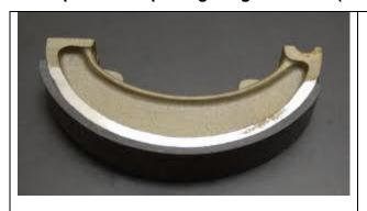
Kampas-kampas rem ini disatukan [dipasangkan] pada sepatu rem dengan perekat (adhesive) yang dikeringkan dengan panas. Selama proses perekatan, bagian belakang kampas rem dan meja dari permukaan sepatu rem dilapisi dengan suatu perekat khusus.
