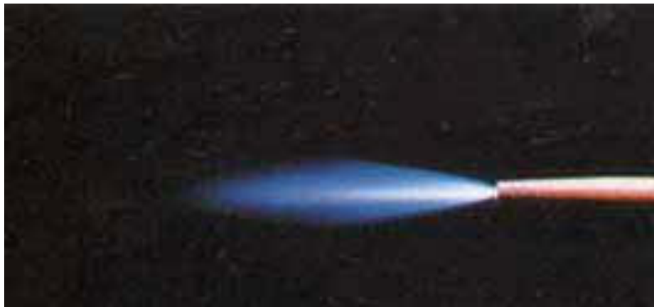
Gambar Api Oxidizing
