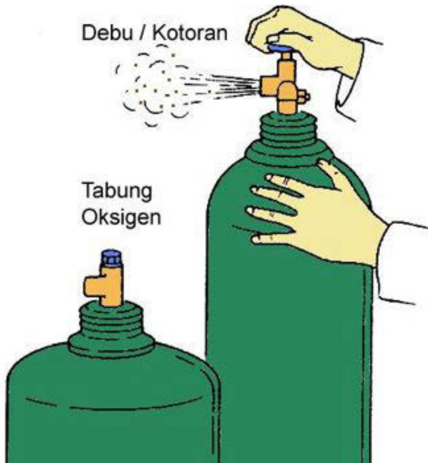
Gambar 7.15. Membuang kotoran di dalam katup tabung oksigen
