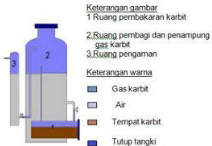
Gambar Tabung pembuat gas acetylene dari karbit
