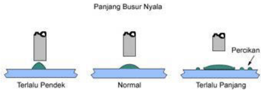
Gambar Pengaruh Panjang Busur Nyala Terhadap Bentuk Jalur Lasan
