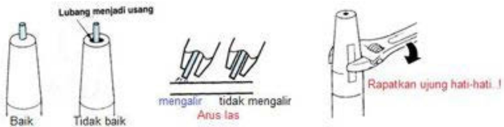
Gambar kondisi ujung kontak
