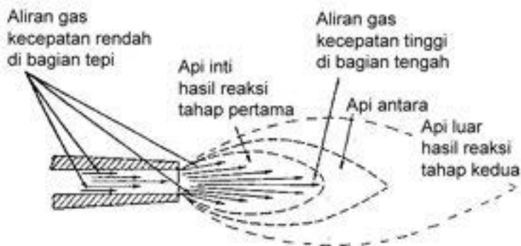
Gambar. Proses terbentuknya nyala oxy-acetylene
