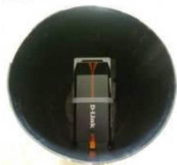
Gambar 5.27. Plat L (non logam) dengan wireless USB adapter yang telah dibaut ke pipa paralon
