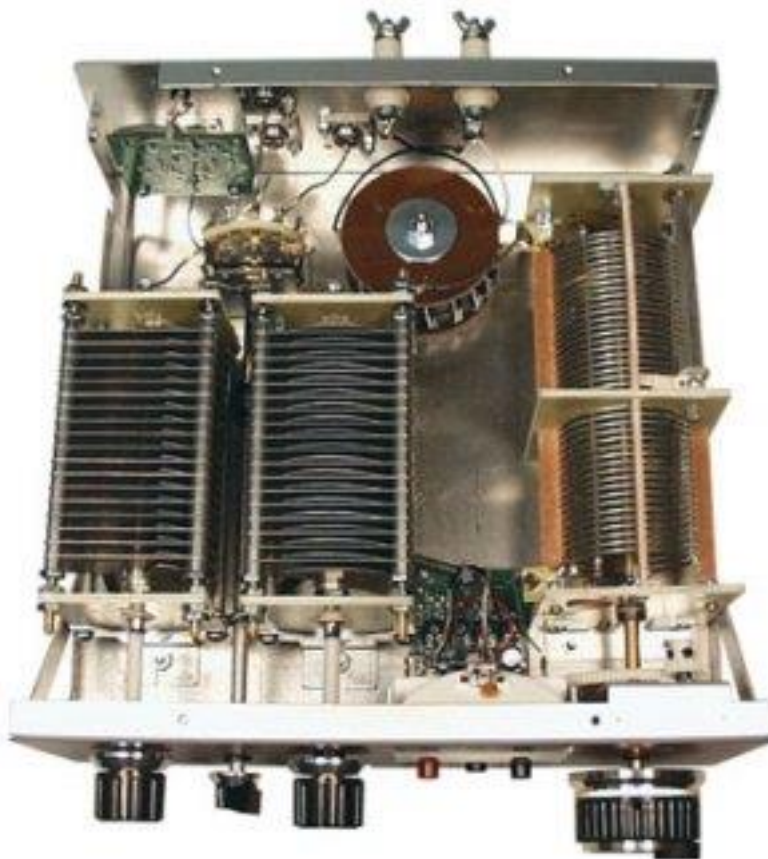
Gambar 1.11. Bagian dalam tuner nntena produk MFJ
