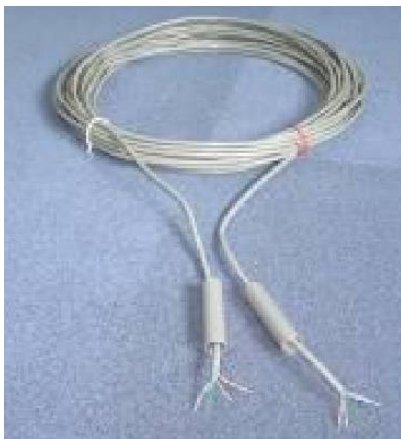
Gambar 5.32. Memasukkan pipa ke kabel sebelum disolder
