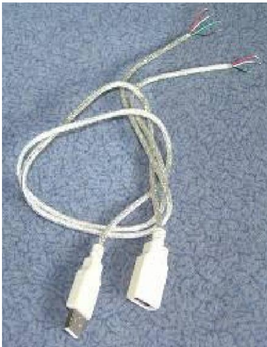
Gambar 5.30. Kabel USB yang dipotong menjadi 2
