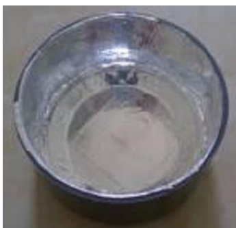
Gambar 5.23. Tutup pipa paralon yang dilapisi dengan lakban alumunium bagian dalamnya
