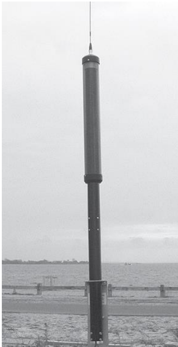
Gambar 1.6. Contoh model antenna mobil HF dengan motorized
