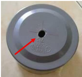
Gambar 5.21. Salah satu tutup pipa 3" yang telah di bor
