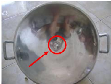
Gambar 5.20. Bagian tengah wajan yang telah di bor
