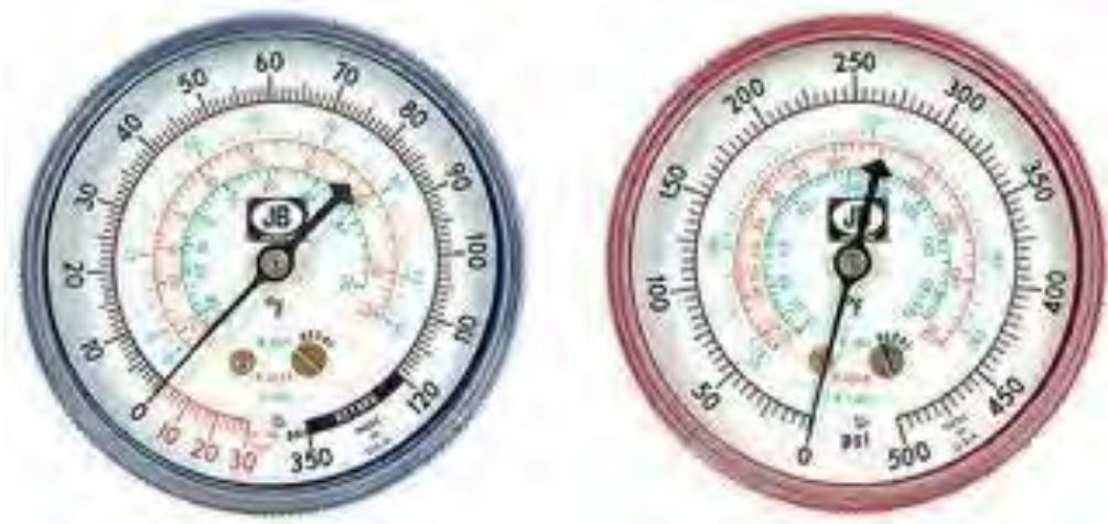
Gambar 4.5 Skala Suhu pada LPG dan HPG
