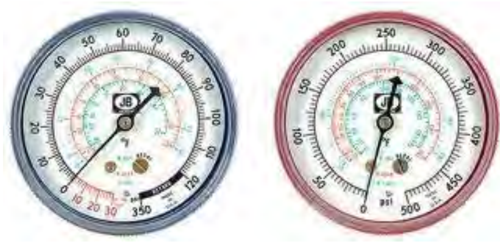
Gambar 4.5 Skala Suhu pada LPG dan HPG
