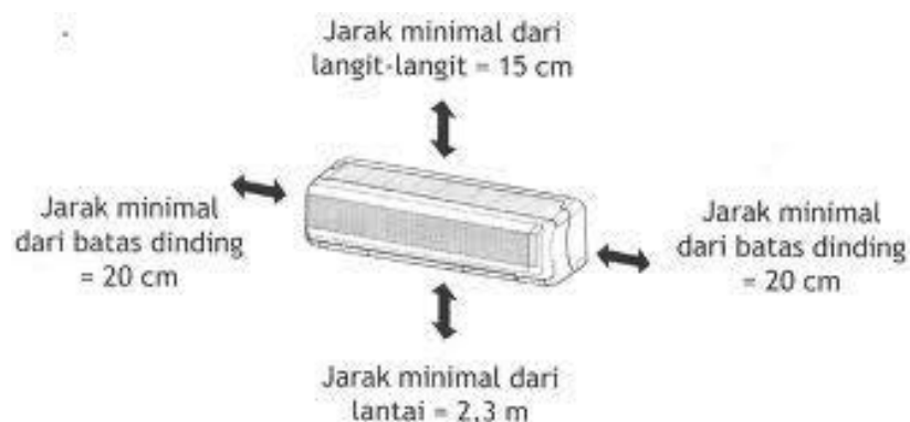
Gambar 6.3 Aturan Penempatan Unit Indoor
