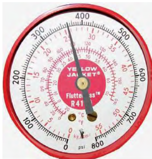
Gambar 4.4 Tipikal Skala pada Gauge Manifold
