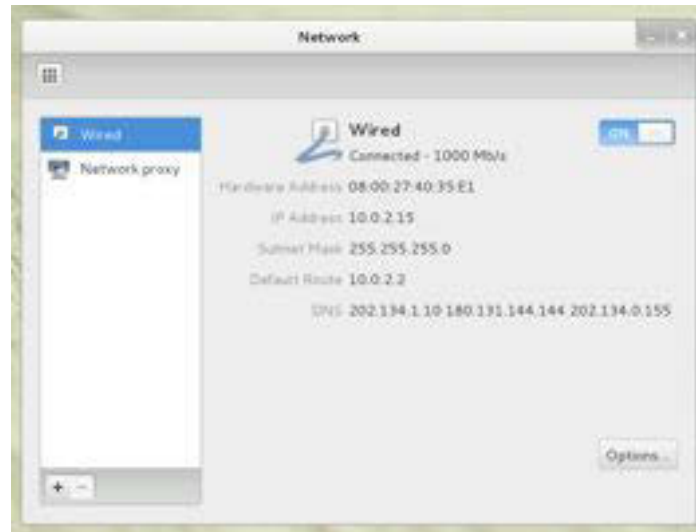
Gambar 24. Alamat gateway pada label Default Route di aplikasi Network Manager
