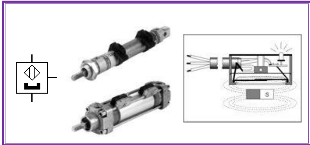
Gambar 4.58 Sensor Proksimiti magnetik (Reedswitch)
