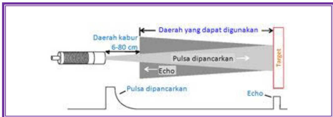
Gambar 4.73 Daerah kabur/buta/gelap sensor ultrasonik
