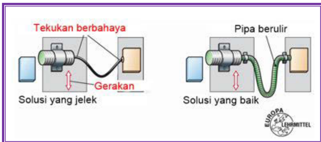
Gambar 4.47 Perakitan sensor bergerak
