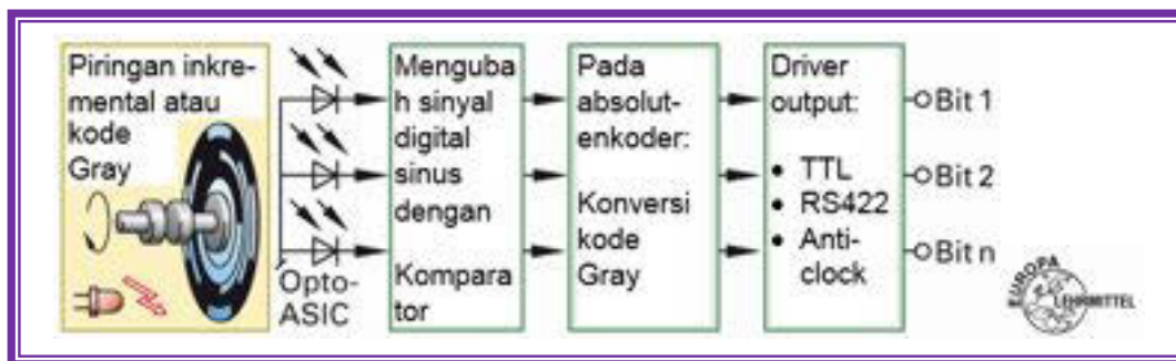
Gambar 4.146 Konstruksi sebuah encoder
