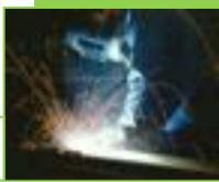
Pengelasan dengan arus searah (elektroda dikutup negative)
