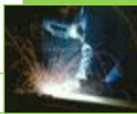
retak dapat dihindari dengan menurunkan arus las pada akhir alur pengelasan.
