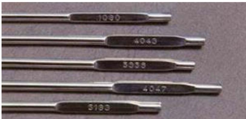
Gambar 8.4 *Filler rod* untuk mengelas Aluminium dan paduannya
