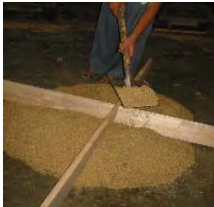
Gambar 12. Mengumpulkan Contoh, Membagi, dan Mencampur Contoh
