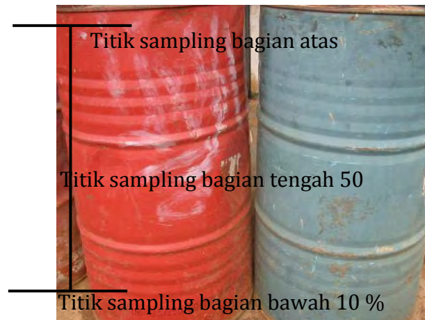
Gambar 2. Cara menentukan titik pengambilan contoh bahan cairan
