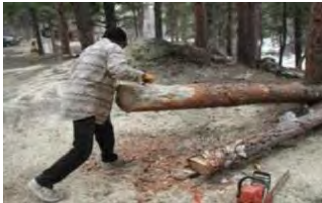
Gambar 24. Pengupasan Kulit Kayu
