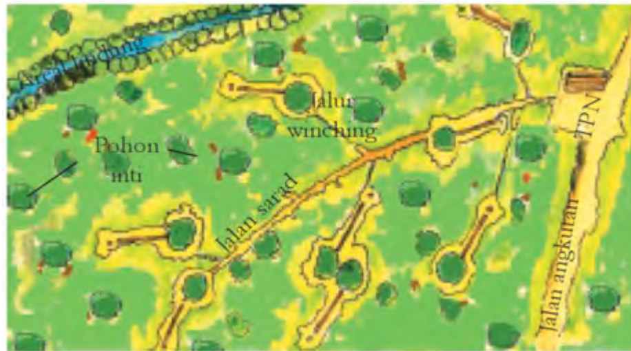
Gambar 1. Penentuan Arah Rebah Pada Jalan Sarat
