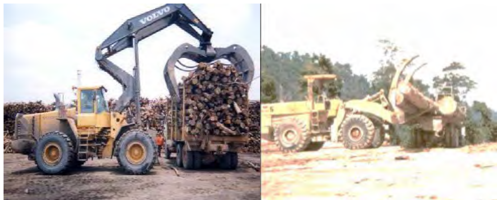
Gambar 90. Pemuatan/Pembongkaran Dengan Wheel Loader
