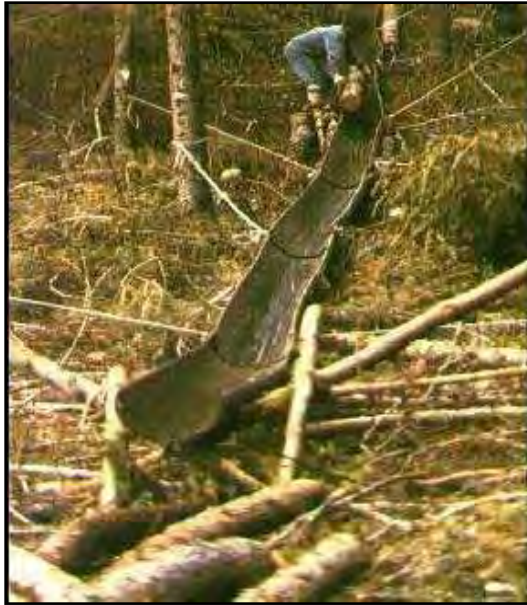
Gambar 70 Penyaradan Sistem Gravitasi
