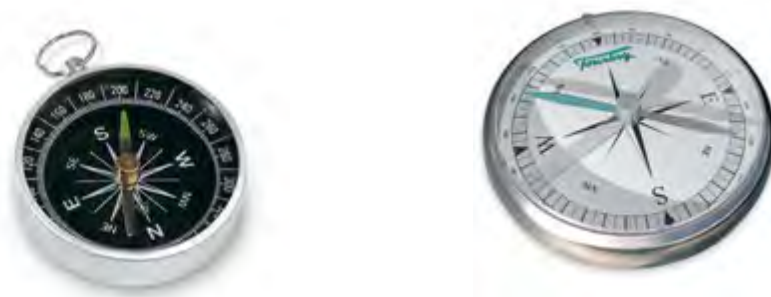
Gambar 1. Kompas sebagai penunjuk arah atau azimuth dalam pengukuran dan pemetaan tanah.
