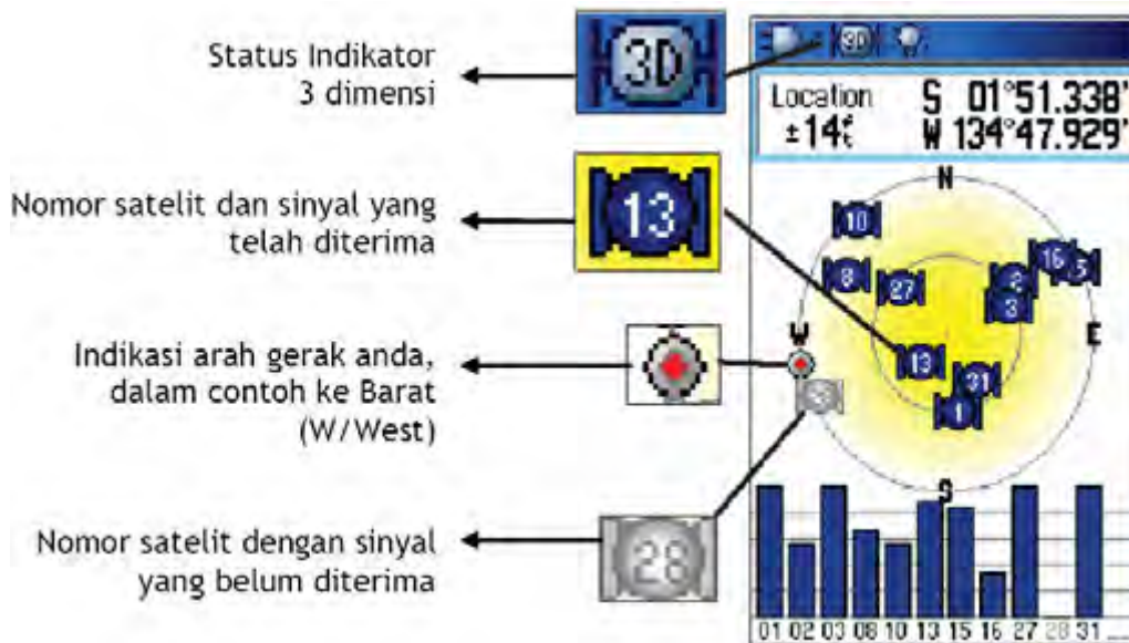
Gambar 7. Fungsi dan keterangan tombol pada contoh GPS yang ada di pasaran
