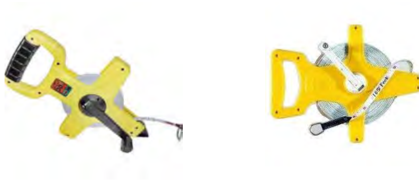
Gambar 3. Rol meter sebagai alat untuk mengetahui jarak dalam pengukuran dan pemetaan tanah.
