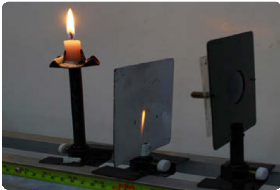
Set Percobaan Pembentukan Bayangan pada Cermin Lengkung
