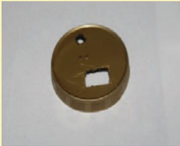
1. Lubangi tutup toples sebesar saklar dengan cutter, sebuah lubang sukuran potensiometer, dan dua lubang kecil menggunakan paku seperti gambar berikut:
