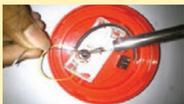
7. Solder kabel tempat baterai di bagian belakang lampu.
